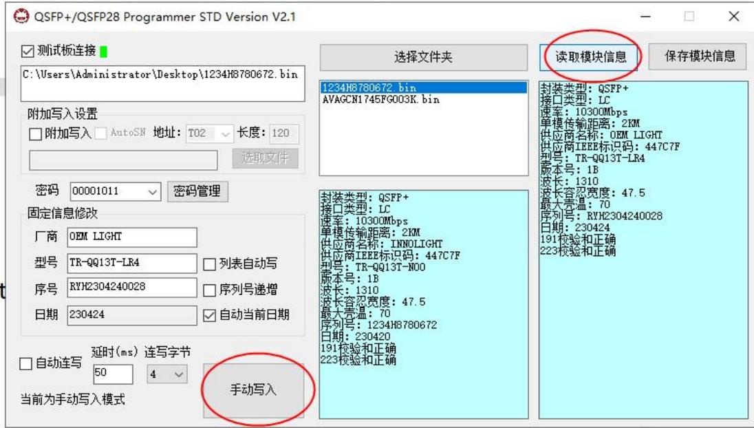
当手动写入按钮变成灰色表示写入完毕，接着点右边的读取模块信息，确认是否写入正确。
